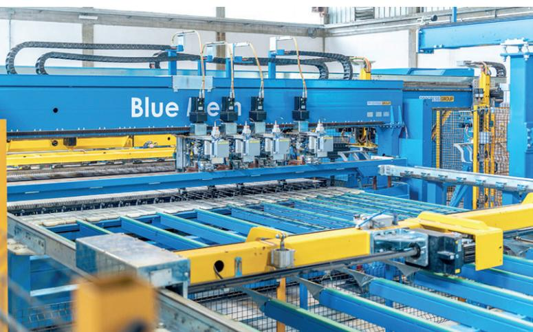
网格焊接设备可以直接从线圈焊接成各种各样的定制网格
