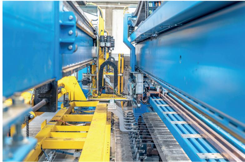
可以在顶部和底部焊接纵向钢筋是 Prefabricati LP 的一项技术创新
