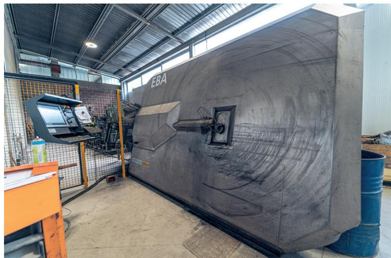
EBA 自动箍条弯曲机生产各种形状和尺寸的箍筋
