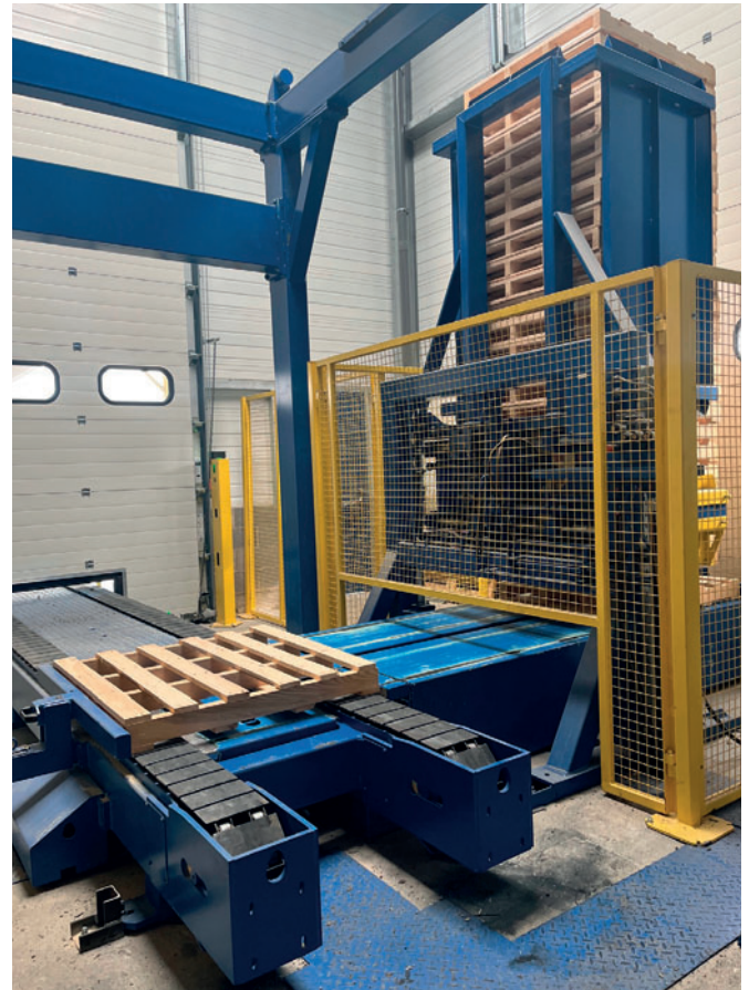
Загрузка магазина поддонов осуществляется снаружи - просто и безопасно
