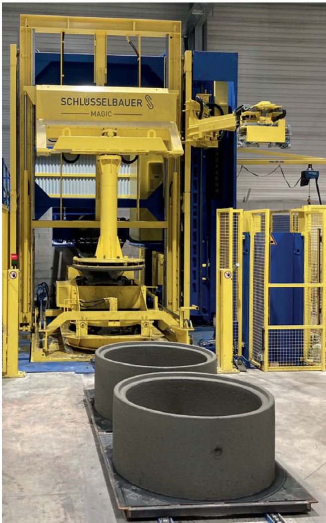
Анкеры и поперечины закладываются автоматически (справа на этой фотографии), а бункер смещен за стену здания. Система Magic была адаптирована к существующим заводским условиям
