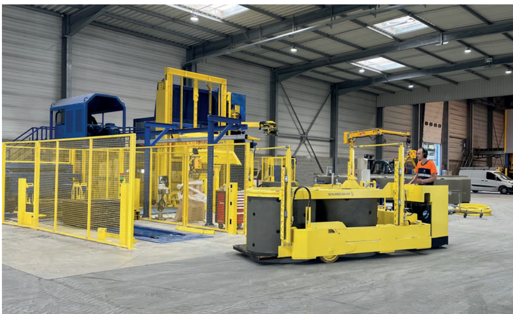
Анкеры и поперечины закладываются автоматически (справа на этой фотографии), а бункер смещен за стену здания. Система Magic была адаптирована к существующим заводским условиям
