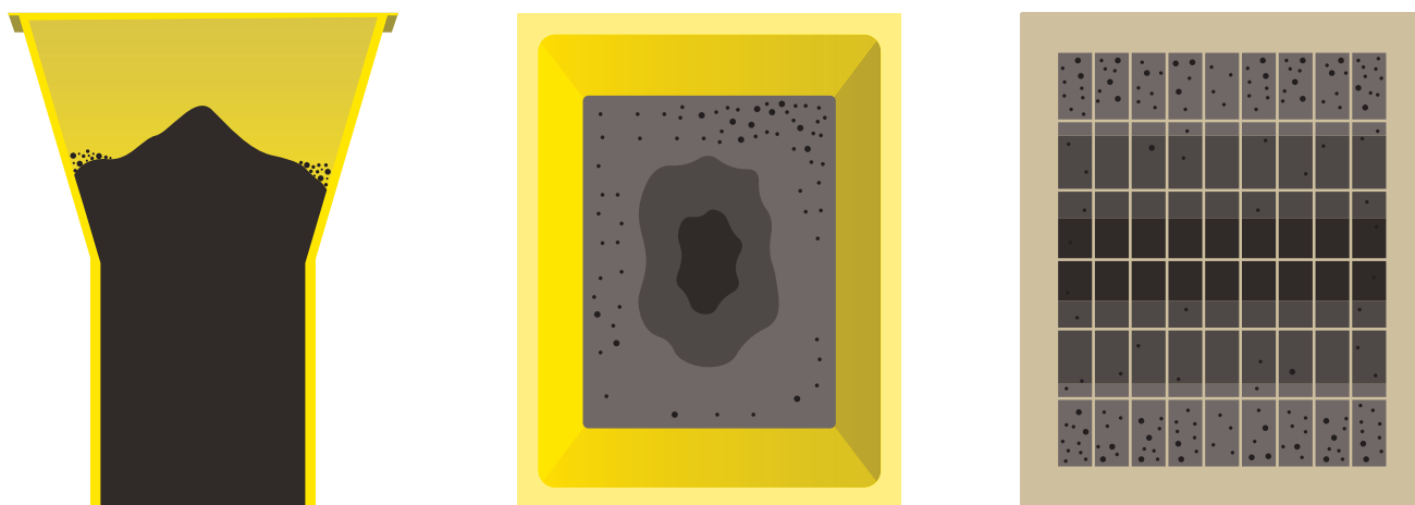
Разрез бункера, вид сверху на бункер, вид сверху на форму: неоднородное распределение бетонной смеси в бункере вибропресса или на технологическом поддоне
