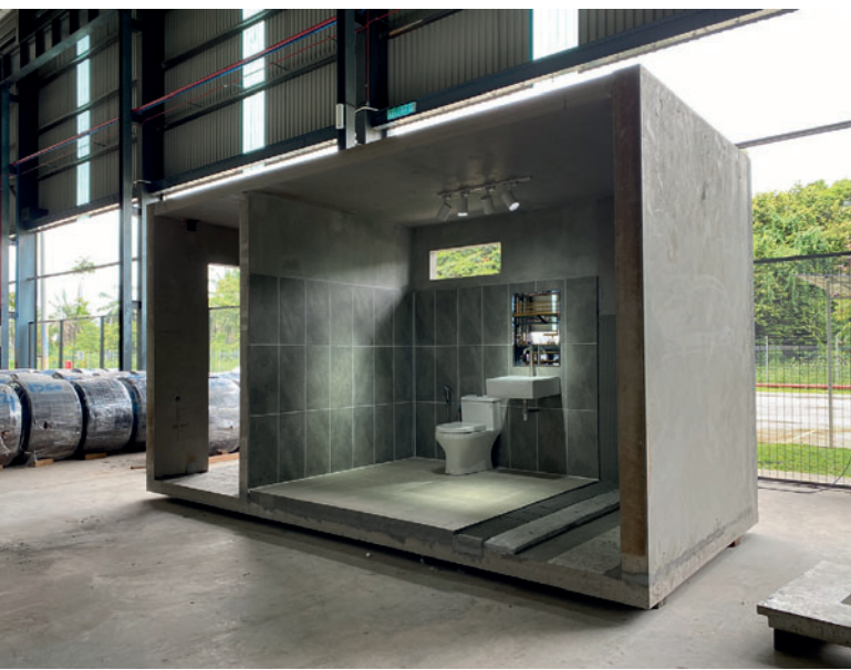
IJM IBS PPVC: готовая сборка и полная архитектурная отделка модуля, полностью готового к оперативной доставке на стройплощадку
