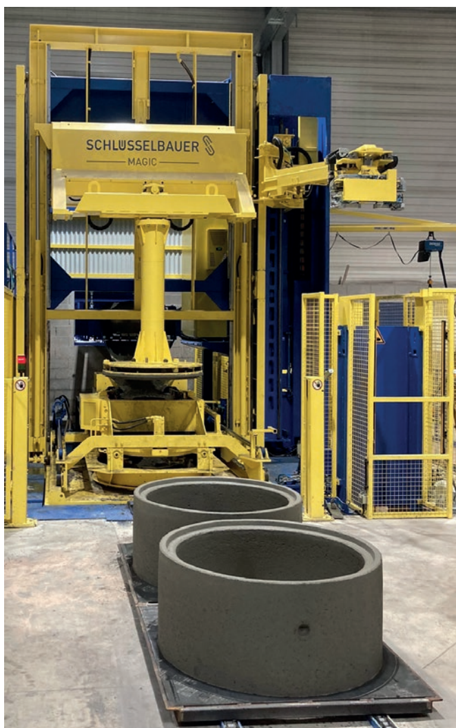
Kotwy i stopnie żłazowe są automatycznie montowane w wyrobach. Maszyna została indywidualnie zaprojektowana aby pasować do egzystującego budynku. Silos znajdują się za ścianką działową.
