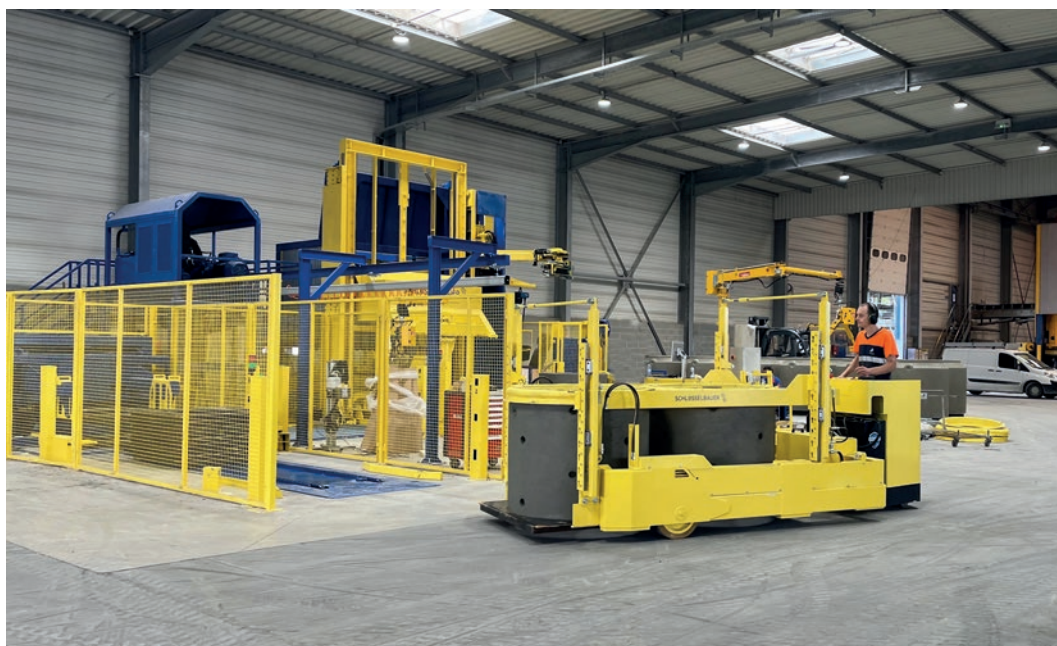
Kotwy i stopnie żłazowe są automatycznie montowane w wyrobach. Maszyna została indywidualnie zaprojektowana aby pasować do egzystującego budynku. Silos znajdują się za ścianką działową.
