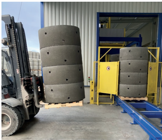
Transport gotowych wyrobów ułożonych na palecie. Przenośnik wywozowy został umiejscowiony wzdłuż budynku, pod zadaszeniem w obszarze chronionym przy zewnętrznej powierzchni magazynowej.
