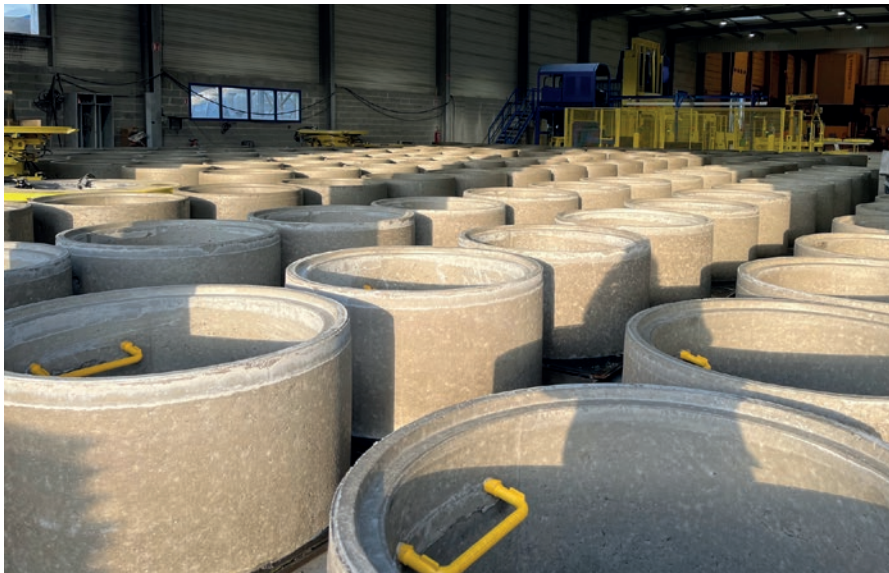
Kręgi wyposażone w kotwy transportowe oraz stopnie żłazowe.
