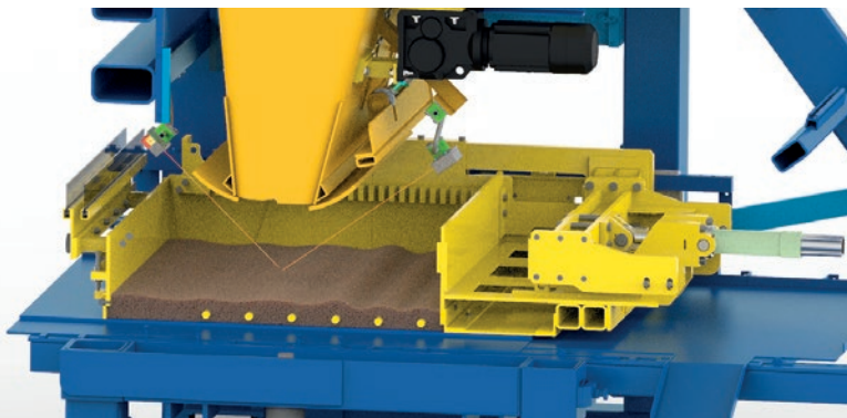
Pomiar ilości mieszanki betonowej za pomocą lasera.
