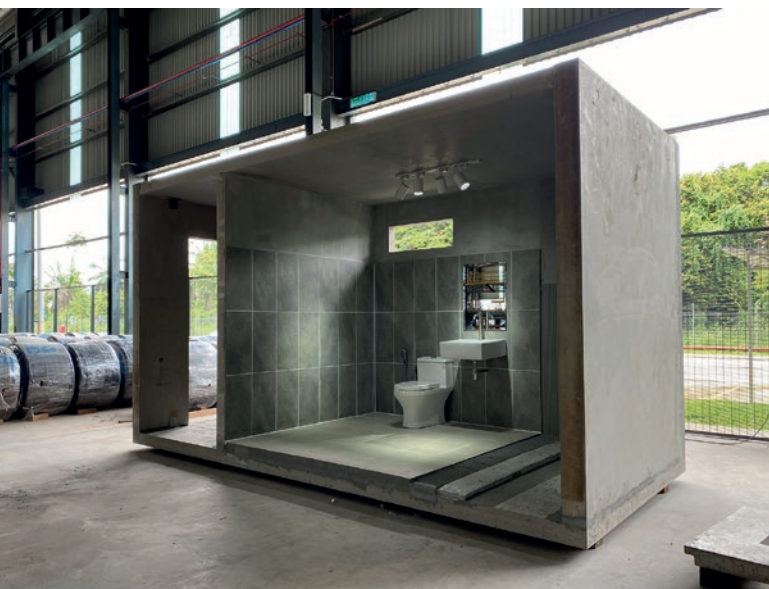
IJM IBS PPVC: Prefabrykowane elementy betonowe z wykończeniem architektonicznym gotowe do sprawnej wysyłki na plac budowy.
