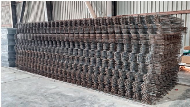
Elastyczne, dostosowane do indywidualnych wymagań zbrojenie elementów prefabrykowanych może być produkowane w sposób w pełni zautomatyzowany przy użyciu nowych maszyn.
