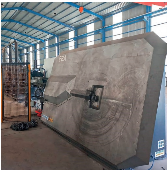
Giętakarka strzemion EBA umożliwia produkcję strzemion w trybie just in time, ze stali w kręgach.
