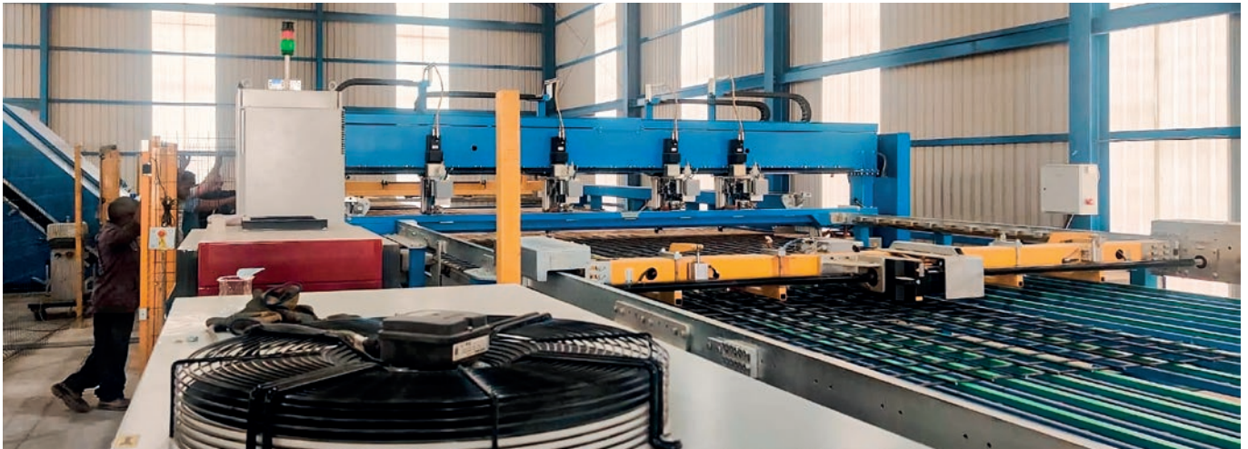
M-System BlueMesh automatycznie zgrzewa siatkę zgodnie z planem za pomocą 4 elastycznych głowic zgrzewających.
