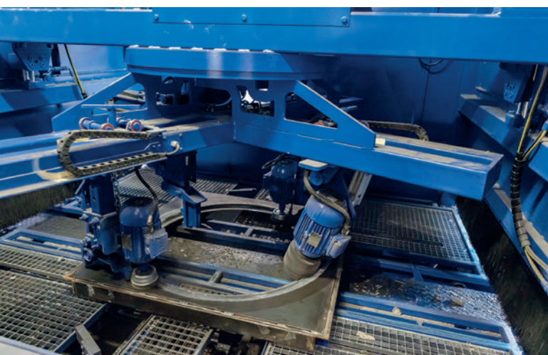
Stazione di pulizia per i fondelli inferiori accanto al dispositivo di oliatura senza nebulizzazione, un classico negli impianti di pallettizzazione a marchio Schlüsselbauer.
