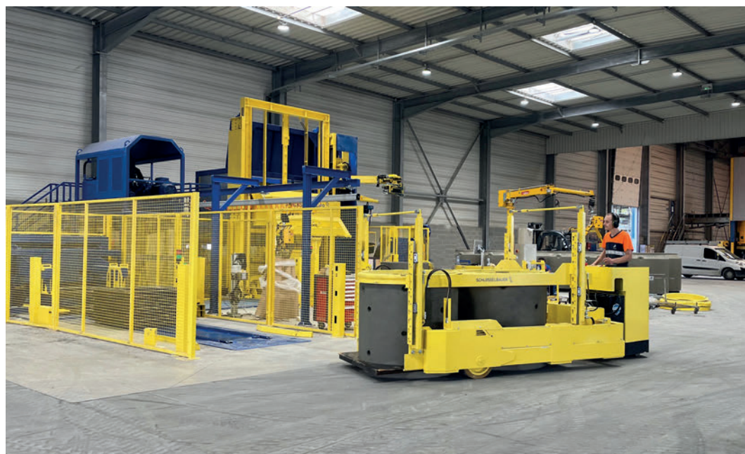
In questo caso, il posizionamento automatico di ancoraggi e gradini avviene da destra mentre il silos è disposto sfalsato dietro la parete dell'edificio: l'impianto Magic è stato adattato su misura all'edificio esistente.
