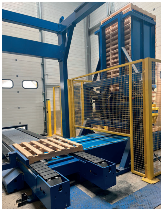
Il caricatore di pallet viene caricato dall'esterno, operazione più agevole e più sicura.
