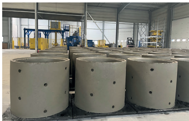
Posizione ottimale dell'area di indurimento (in questo caso con anelli per pozzetti dotati di fori di drenaggio) nel capannone tra il macchinario di produzione e l'impianto di pallettizzazione.
