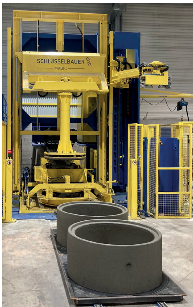
In questo caso, il posizionamento automatico di ancoraggi e gradini avviene da destra mentre il silos è disposto sfalsato dietro la parete dell'edificio: l'impianto Magic è stato adattato su misura all'edificio esistente.
