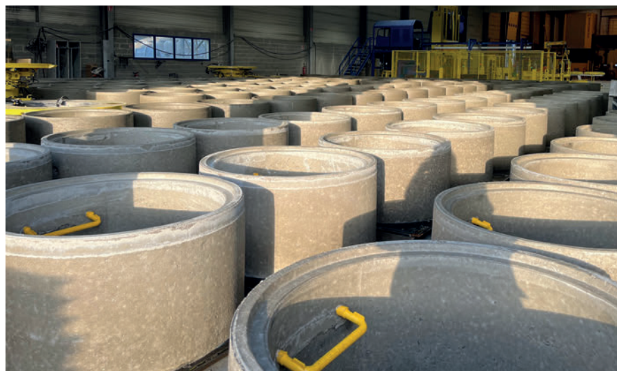
Anelli per pozzetti, con gradini e ancoraggi
