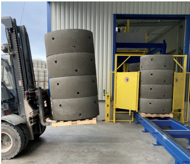
Trasporto dei prodotti finiti, impilati sui pallet. Il nastro trasportatore è stato posizionato in un punto strategico: lungo l'edificio sotto una pensilina, in un'area protetta accanto alla via di corsa e all'area di stoccaggio esterna.
