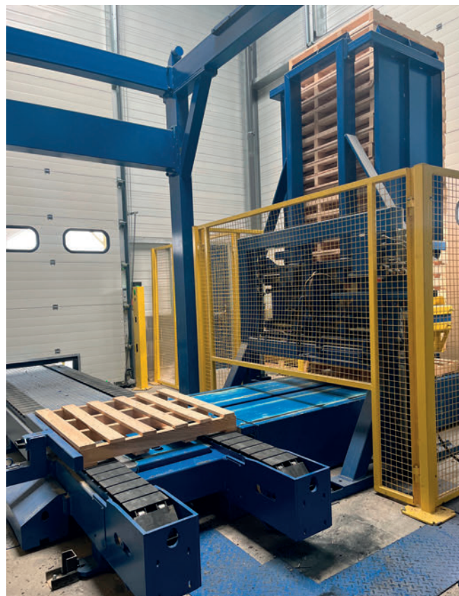
Le magasin à palettes se charge par l'extérieur, ce qui est plus facile et plus sûr
