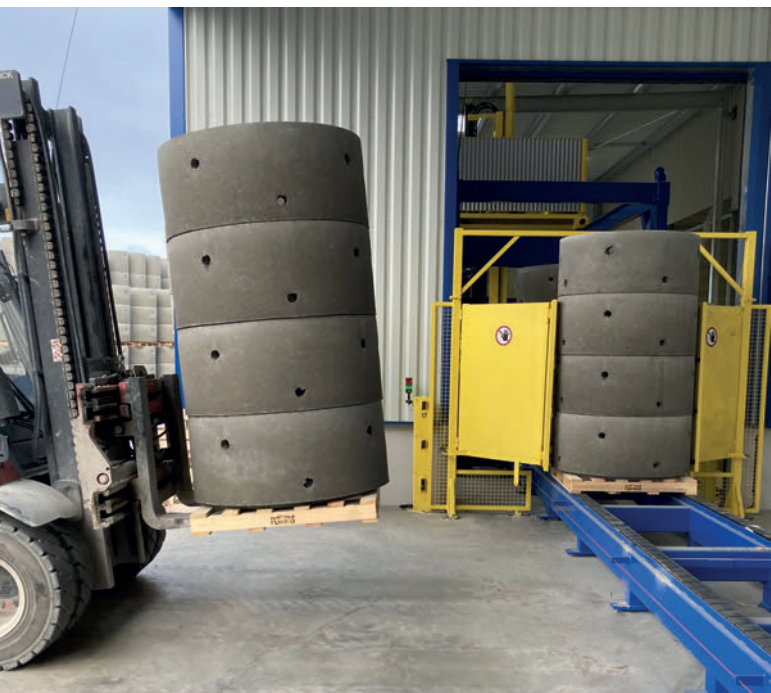
La sortie des produits finis, empilés sur palette. Le convoyeur a été placé de manière optimale le long du bâtiment, sous un auvent : zone protégée à côté de la voie de circulation et du parc de stockage extérieur.
