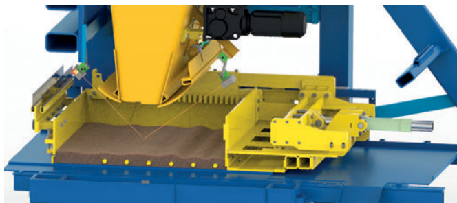
Mesure de la quantité de béton par laser
