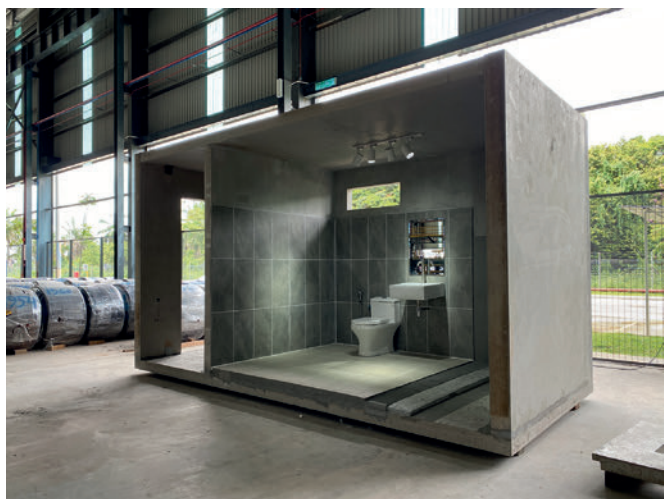
PPVC IJM IBS : construction préfabriquée et entièrement recouverte de finitions architecturales, prête pour une livraison efficace sur le chantier.
