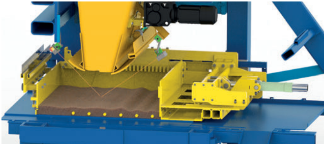
Medición de la cantidad de hormigón mediante láser
