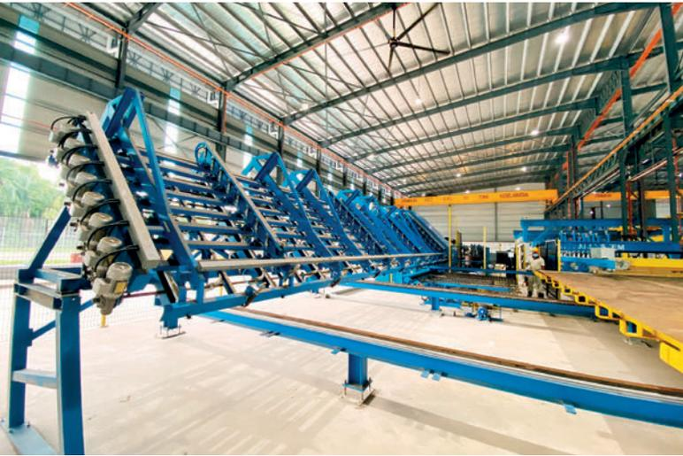
La instalación de soldadura de mallas M-System Evolution de última generación produce mallas de armadura a medida para elementos prefabricados de hormigón.
