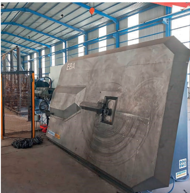
La estribadora automática EBA permite la producción justo a tiempo de estribos partiendo de bobinas.
