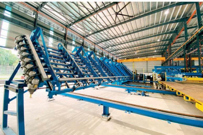
Die M-System Evolution ist eine fortschrittliche Mattenschweißanlage, die maßgeschneiderte Bewehrungsmatten für Betonfertigteile herstellt
