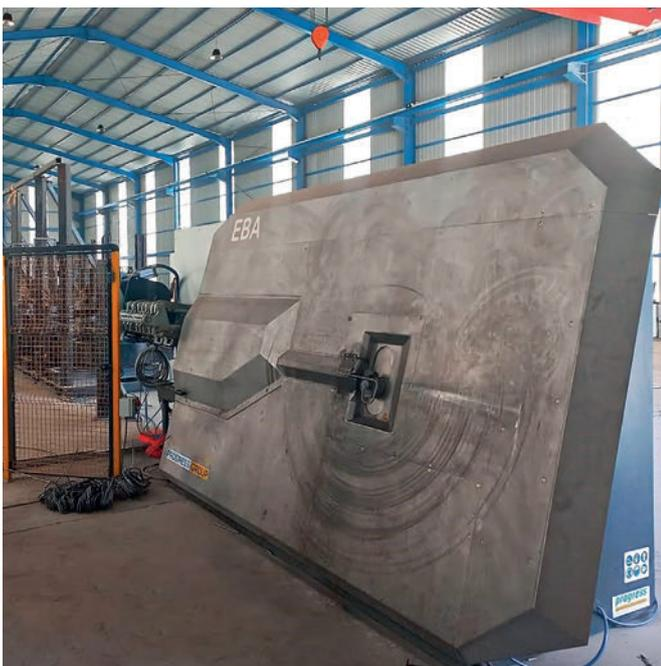
Der EBA-Bügelbiegeautomat ermöglicht eine Just-in-time-Produktion von Bügeln vom Coil
