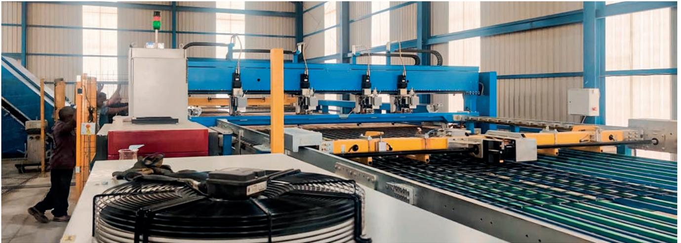
Die M-System-BlueMesh-Anlage schweißt die maßgeschneiderte Matte mit 4 flexiblen Schweißköpfen automatisch nach Plan
