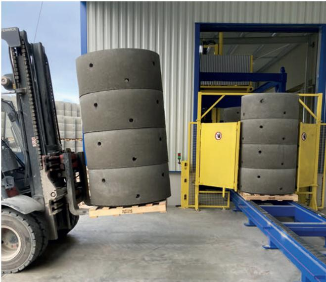
*Der Abtransport der fertigen Produkte, gestapelt auf Palette. Das Transportband wurde optimal positioniert: entlang des Gebäudes unter einem Vordach, in einem geschützten Bereich neben der Fahrbahn und dem Außenlagerbereich.*
