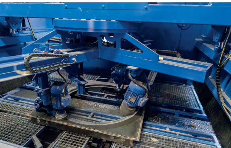
*Reinigungsstation für die Untermuffen, neben der Sprühnebel-freien Ölung ein Klassiker bei den Palettieranlagen von Schlüsselbauer*
