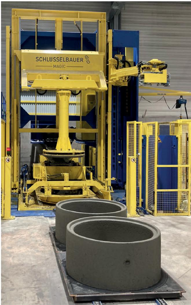
*Die automatische Positionierung der Anker und der Steigbügel erfolgt hier von rechts und das Silo ist hinter der Gebäudewand versetzt angeordnet: Die Magic-Anlage wurde maßgerecht an das bestehende Gebäude angepasst.*
