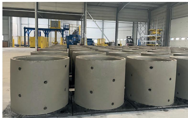
*Optimale Lage des Aushärtebereichs (hier mit Brunnenringen mit Sickerlöchern) im Hallenbereich zwischen Produktionsmaschine und Palettierung*
