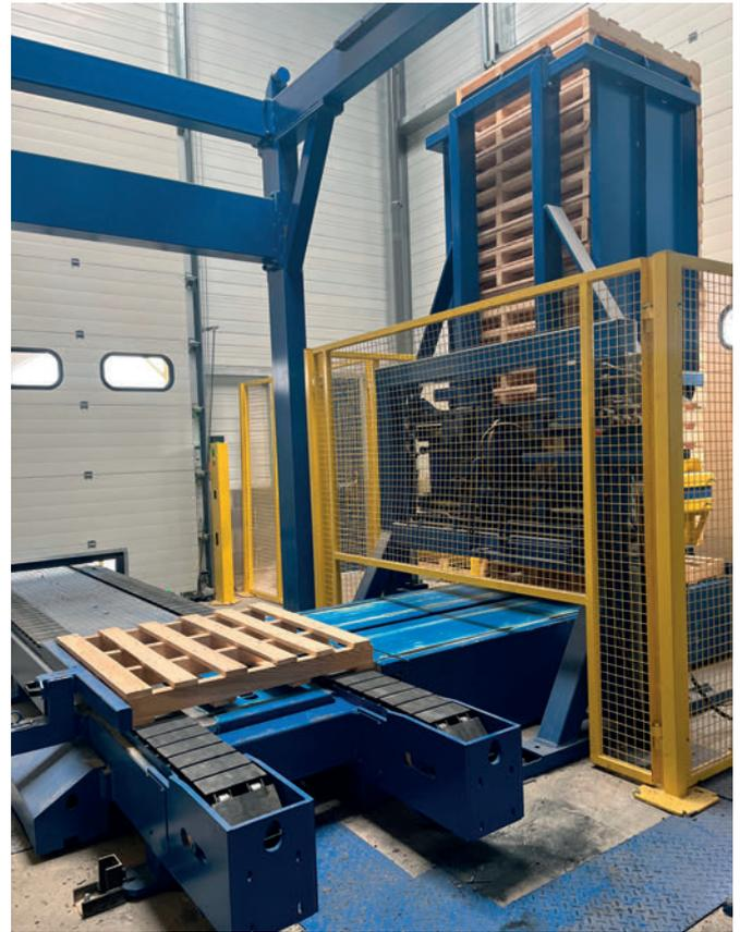
*Die Beladung des Palettenmagazins erfolgt von außen, was einfacher und sicherer ist*
