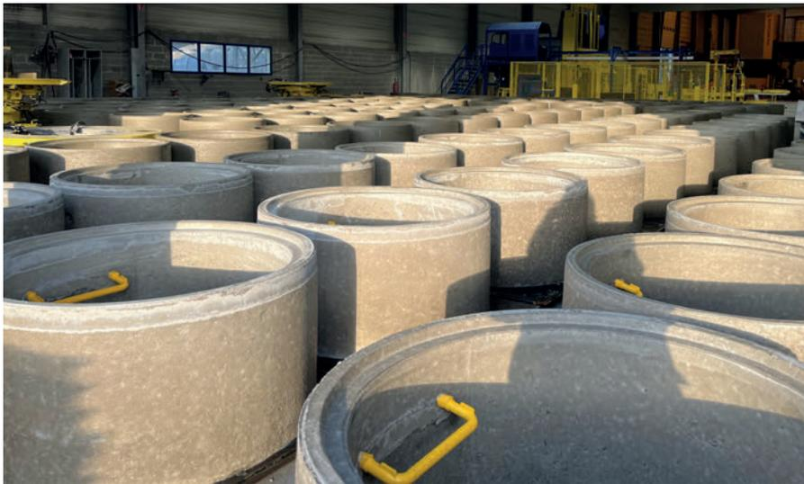
Schachtringe, mit Steigbügel und Ankern
