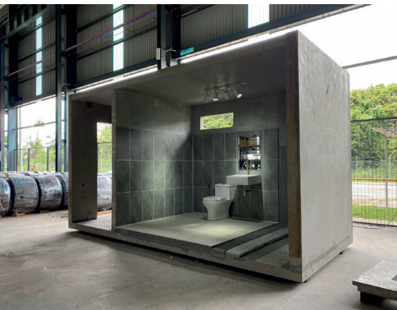
IJM IBS PPVC: 带有建筑涂装的预制品, 可直接运往建筑工地
