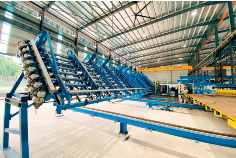
M-System Evolution 是高端钢筋网焊接生产线，可为预制构件生产定制化的钢筋网
