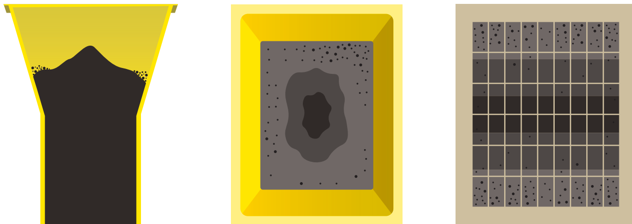
机筒仓断面、机筒仓俯视图、模具俯视图：新拌混凝土在砌块机的筒仓内或在成品板上分布不均
