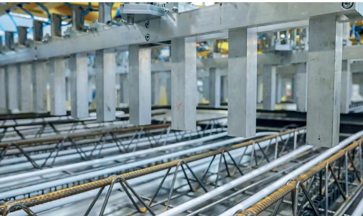
*Робот может укладывать трубы непосредственно на уже установленную арматуру и является прекрасной альтернативой трудоемкой работе вручную*
