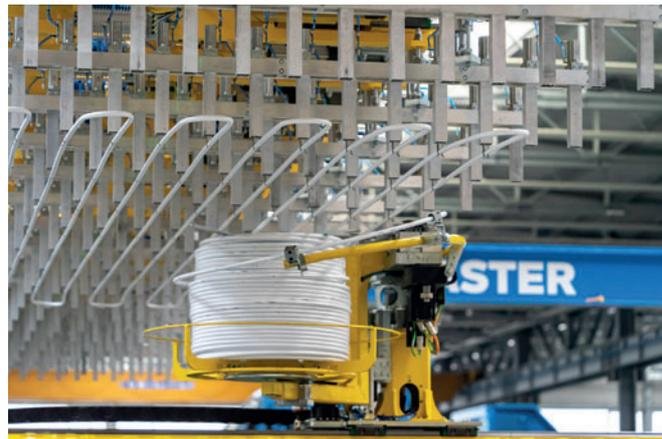
*Робот Tube Master был специально разработан компанией Progress Group для гибки и укладки труб при производстве сборных железобетонных элементов*
