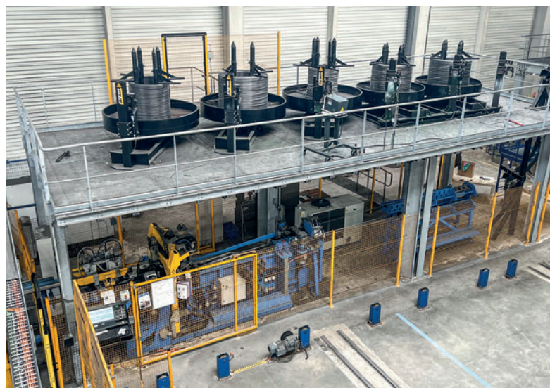
Машина для сварки решетчатых балок Versa была установлена под бухтами для экономии места и может производить решетчатые балки точно в срок
