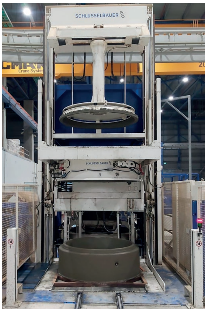
Maszyna MAGIC do wysokowydajnej produkcji kręgów o średnicach nominalnych DN800, 1000, 1250 oraz 1500.
