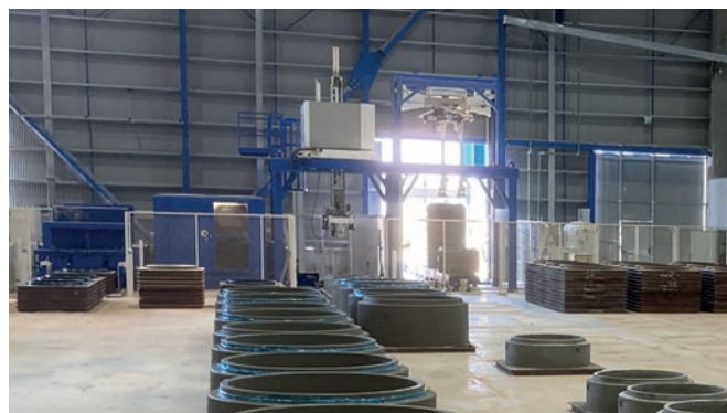
Produkcja i depaletyzacja wyrobów, czyszczenie i olejowanie podkładów - wszystkie te procesy są zautomatyzowane.
