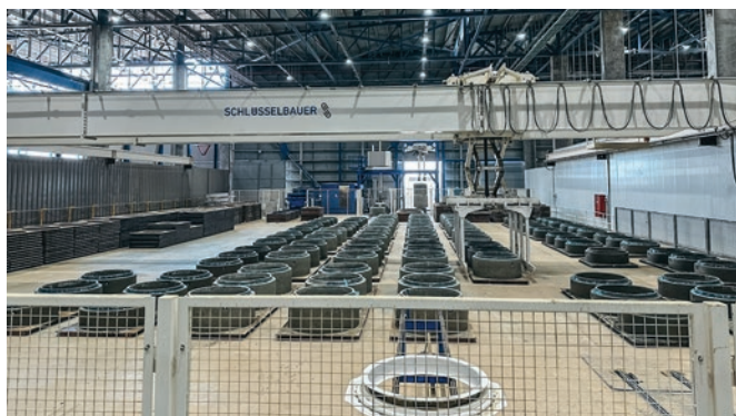
Obszar dojrzewania kręgów betonowych obsługiwany jest przez automatyczną suwnicę Transexact.
