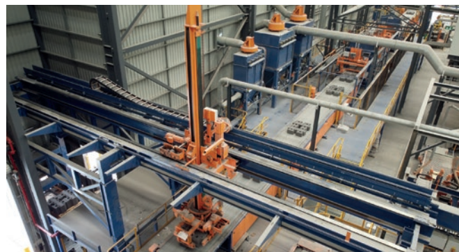
Paletyzator na pozycji 251 z przenośnikiem taśmowym doprowadzającym wyroby na linię łupania, widok z góry.
