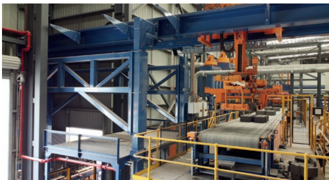
Paletyzator na pozycji 251 z przenośnikiem taśmowym doprowadzającym wyroby na linię łupania, widok z góry.
