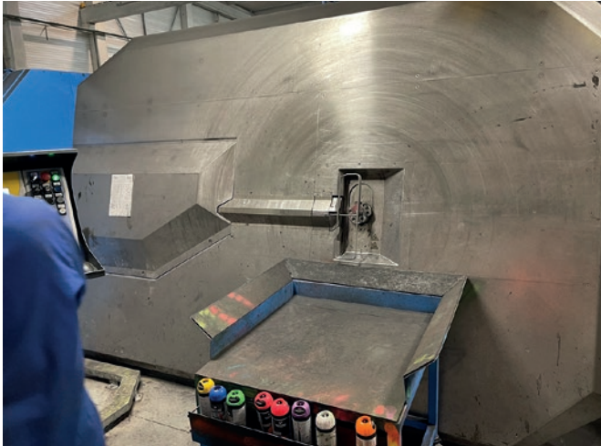
Pluristar to automat do zginania strzemion, prościarka i podwójna giętarka.
