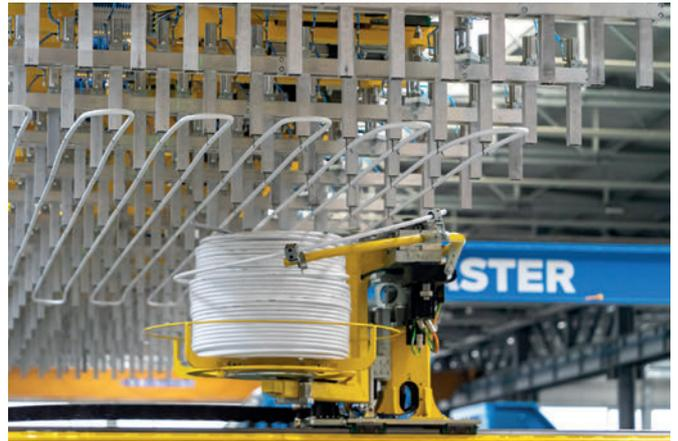
*Il Tube Master è stato messo a punto dal Progress Group appositamente per piegare e posare tubi all'interno della produzione di elementi prefabbricati in calcestruzzo.*
