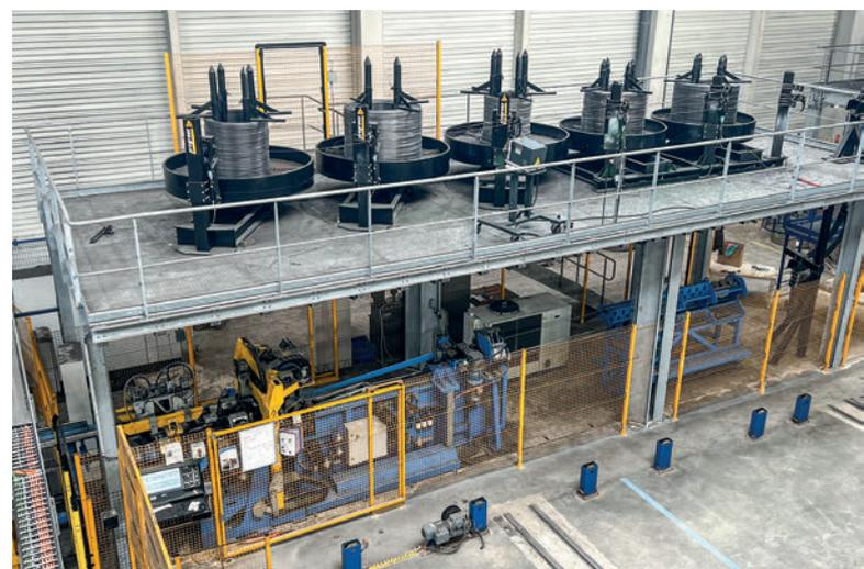
*La saldatrice di tralicci Versa, installata sotto i coil per risparmiare spazio, è in grado di produrre i tralicci just-in-time.*
