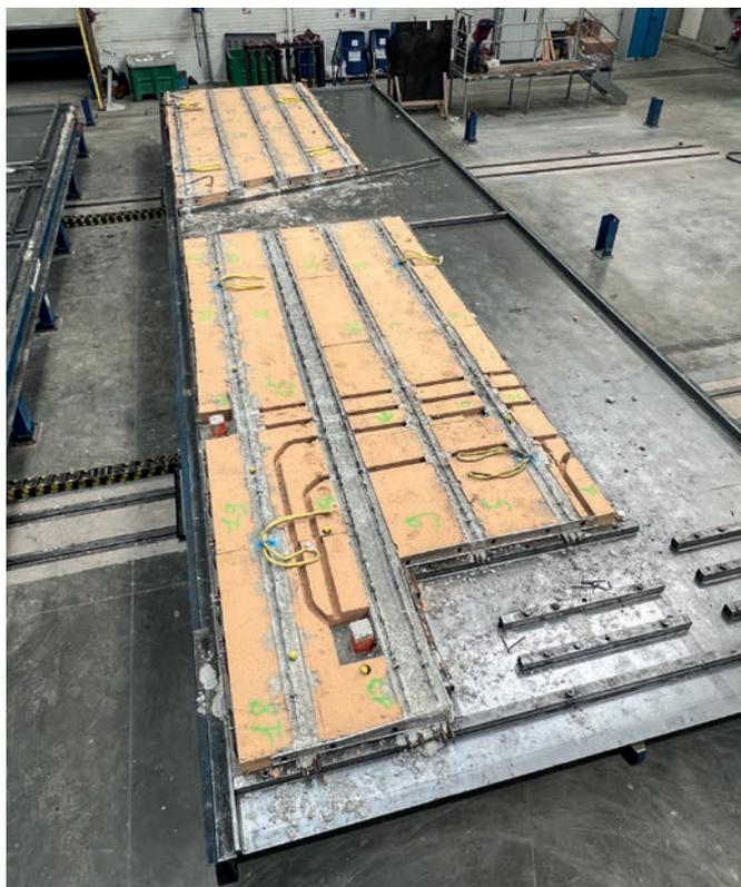
La lavorazione speciale per plottare e scanalare le cavità per i tubi nel legno del solaio prefabbricato BB è una trasformazione della macchina di taglio per materiali isolanti.
