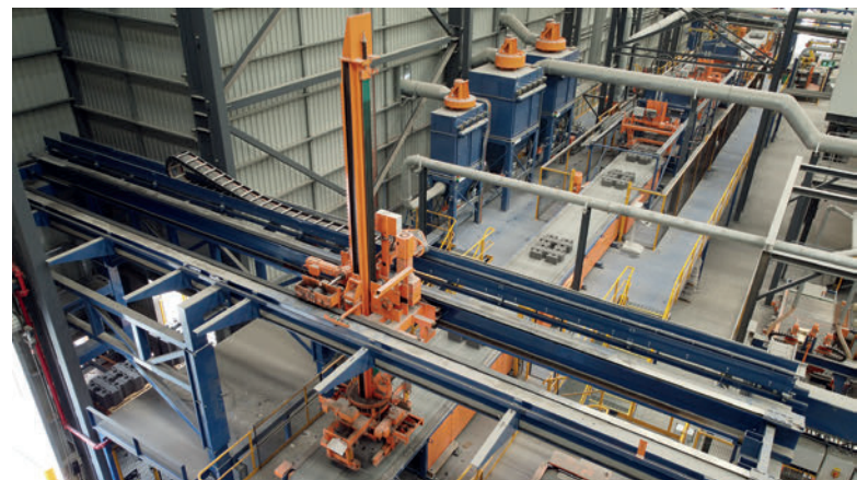
Vista dall'alto sull'impacchettatrice (pos. 251) con nastro trasportatore per il convogliamento alla linea di splittaggio
