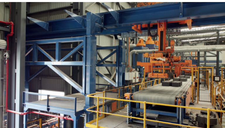
Vista dall'alto sull'impacchettatrice (pos. 251) con nastro trasportatore per il convogliamento alla linea di splittaggio
