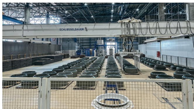
La zone de séchage des regards standardisés avec la grue automatique Transexact.
