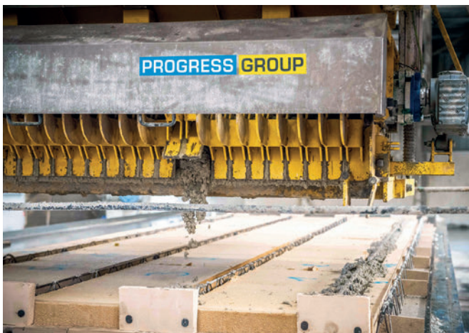
Le distributeur de béton fonctionne exactement selon les quantités calculées, ce qui permet d'économiser du béton.
