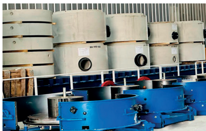
Con la pinza giratoria hidráulica, las bases para pozos Perfect se desencofran de los moldes y se colocan en la posición de montaje.
