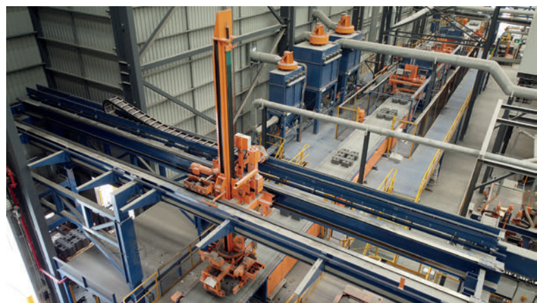
Vista superior de la empaquetadora (pos. 251) con cinta transportadora para la alimentación a la línea de esplitado
