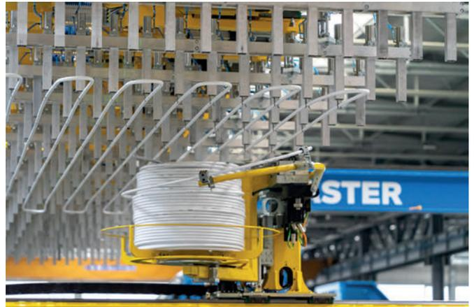
Progress Group desarrolló el robot Tube Master especialmente para el doblado y la colocación de tubos dentro de la producción de prefabricados de hormigón.
