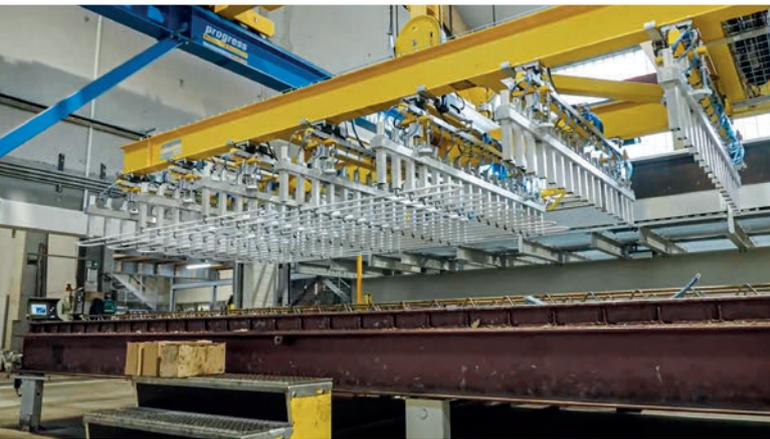
La instalación de la nueva planta automatizada se llevó a cabo con la producción en marcha y convence con su producción diaria de hasta 300 m<sup>2</sup>.
