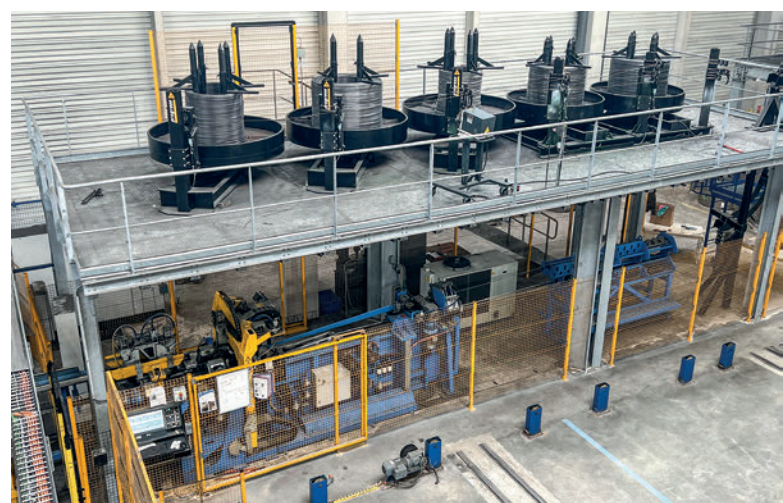
La soldadora de armaduras de celosía Versa se instaló ahorrando espacio debajo de las bobinas y puede fabricar las armaduras de celosías en el momento justo.
