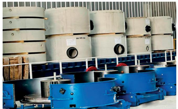
*Mit dem hydraulischen Wendegreifer werden Perfect-Schachtunterteile aus den Formen entschalt und in Einbaulage gedreht.*
