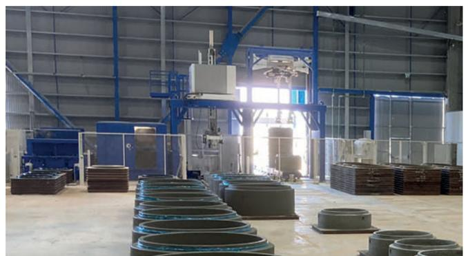
Vollautomatisch erfolgen neben der eigentlichen Fertigung auch das Palettieren der Produkte, das Reinigen und Ölen der Muffen.
