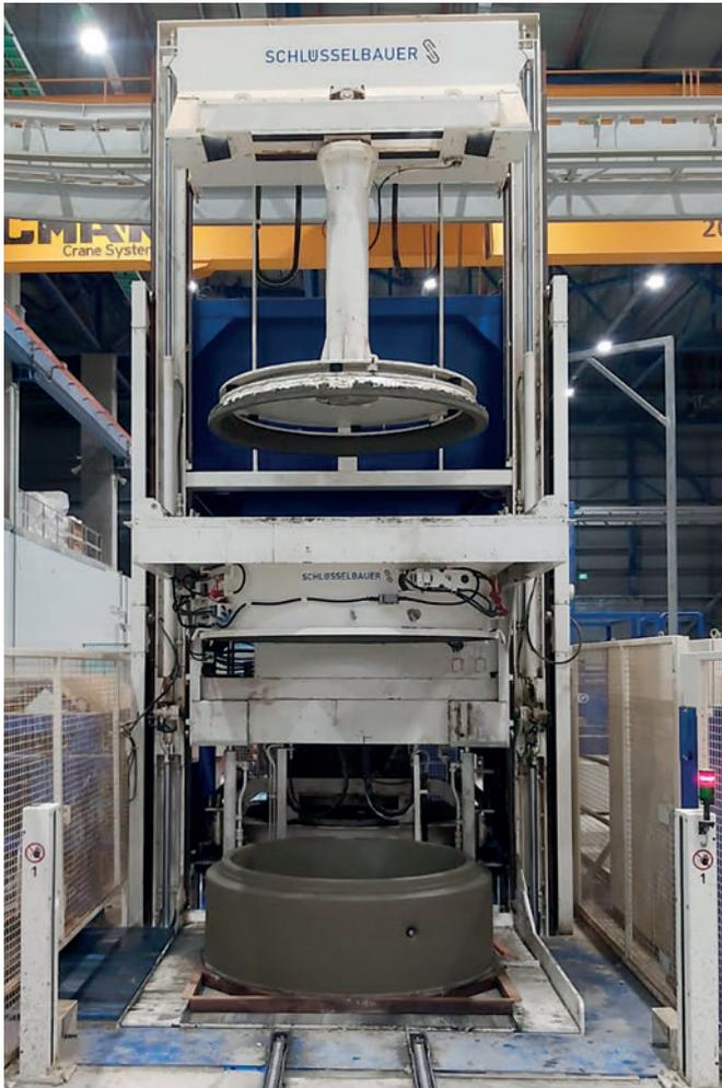
Die Anlage Magic für die Massenfertigung von Schachtringen der Nennweiten 800, 1.000, 1.250 und 1.500 mm
