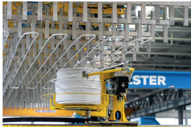
Tube Master 是由 Progress Group 专门开发的，在预制混凝土构件生产中弯曲并安装管道
