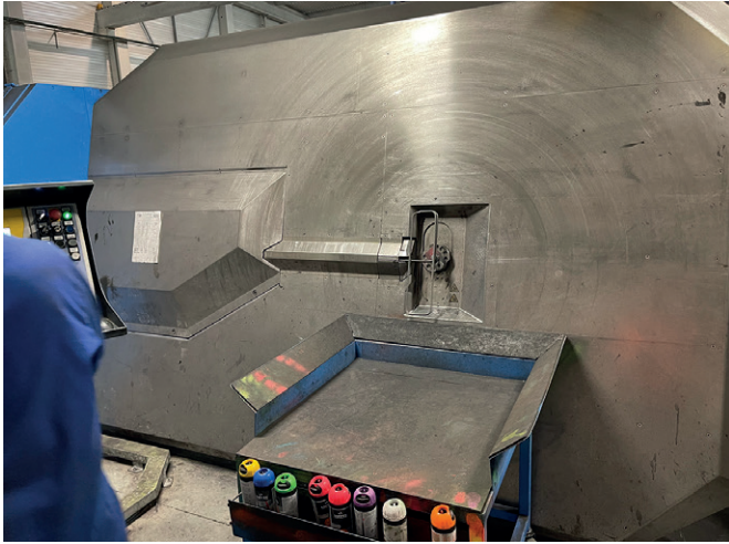
Pluristar 集自动钢筋弯曲机、矫直机和双弯曲机为一体
