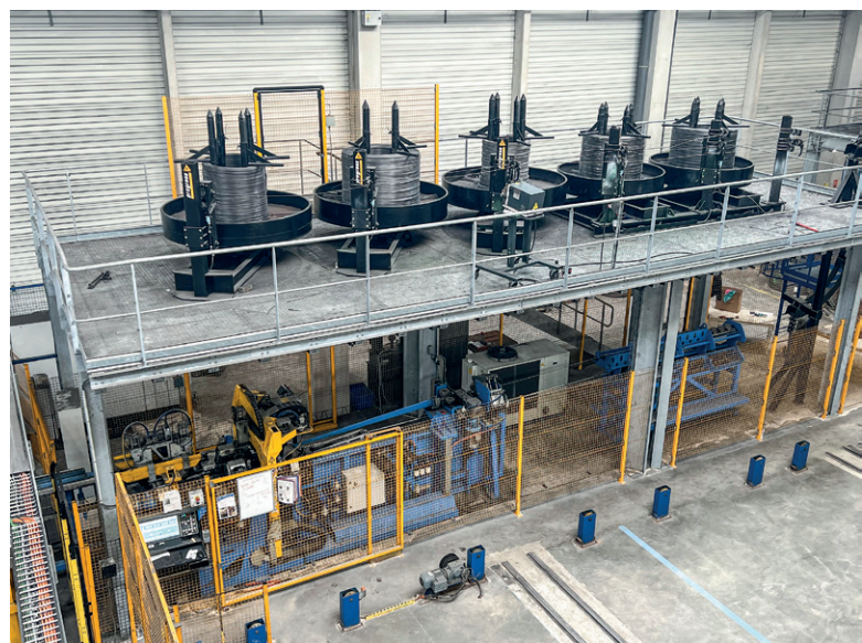
在钢圈下安装了 Versa 格梁焊接机，既节省了空间，又能及时生产格梁
