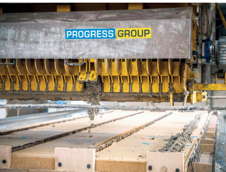
混凝土摊铺机按计算量精确工作，节约混凝土
