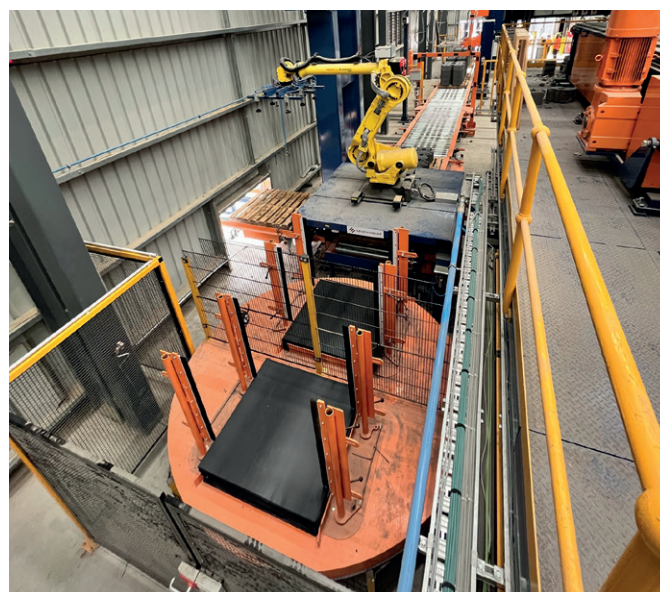
机器人和安装了料仓的可旋转工作台
