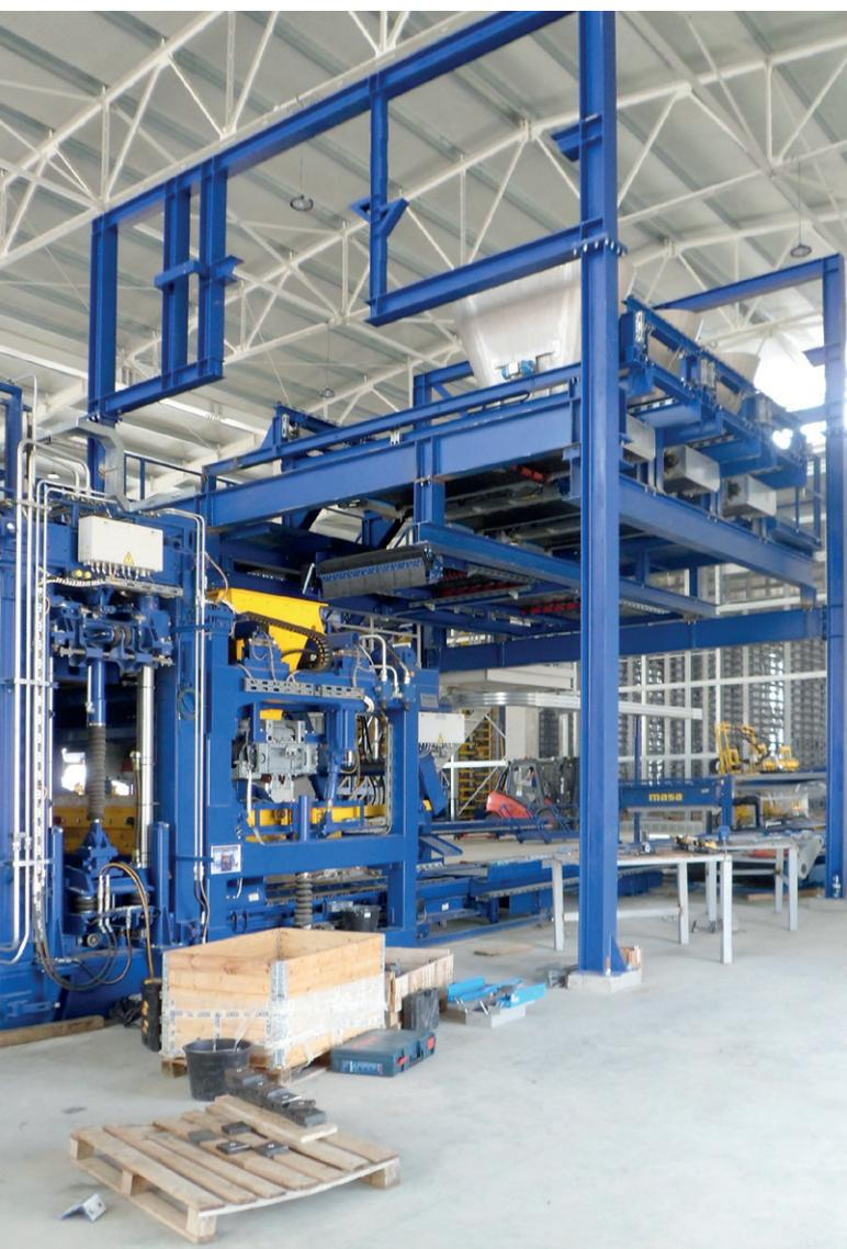
生产工厂的核心设备 Masa XL-R 与多色系统（此处用于面拌混凝土），其组装按照常规流程，同时需要注意设备的敏感特性
