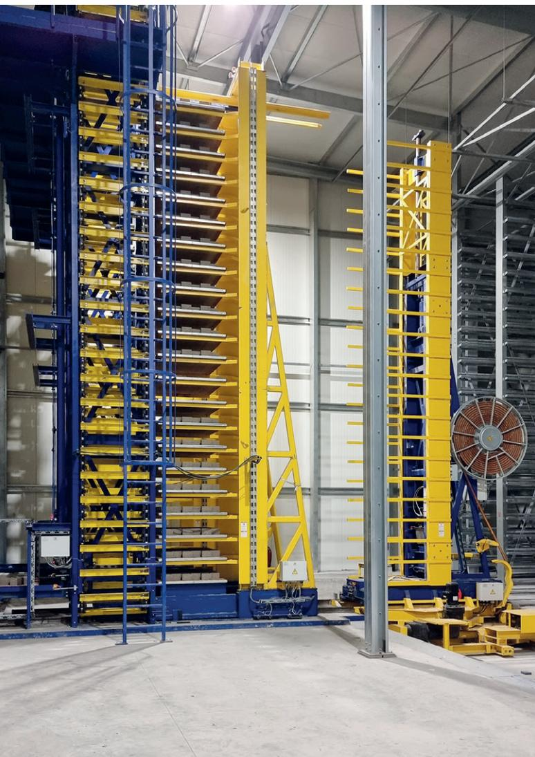
为了将固化产品从固化区转移至回程运输工序，Masa 工厂的控制系统会统一协调部件子母机、中间子母机和下降机
