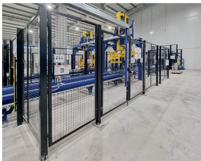
两个平行导向回程运输工具上的定心装置 I 和 II 通过松开、定心产品层，将生产板上的固化产品进行立体加工
