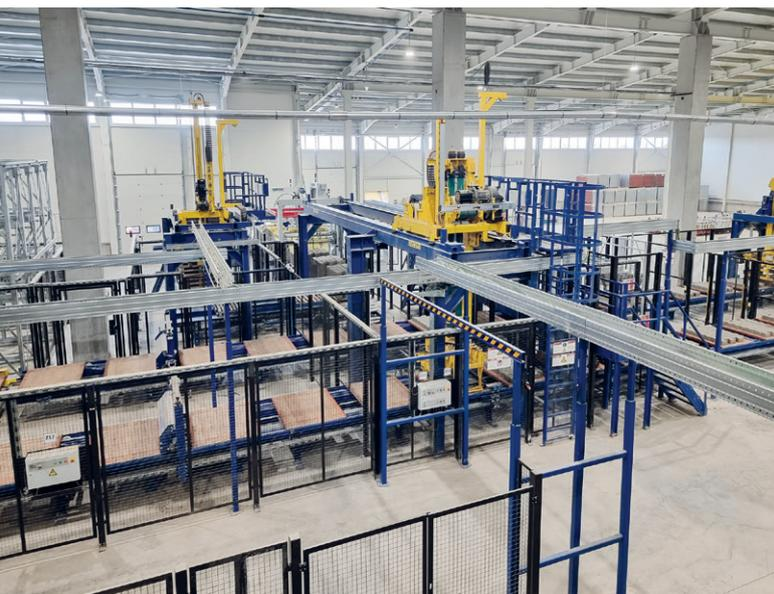
配有 Masa 技术的复杂工厂：包含两个回程运输工序的干测线，Cuboter 设备，以及用于空生产板的运输托盘抓取器和进料系统。作为一家全面供应商，Masa 公司也提供电缆槽
