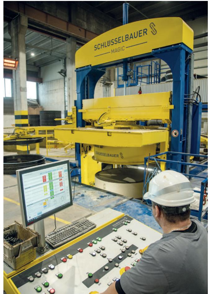
Для аккуратной распалубки свежееотформованного элемента пресс-форма и пресс поднимаются циклично
