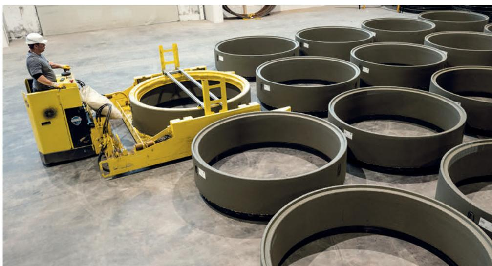
*Transport précautionneux des produits frais jusqu'à la zone de séchage à l'aide du chariot de transport et d'un manipulateur de conformateurs.*
