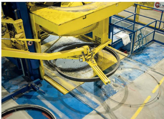
*Pour chaque cycle de fabrication une embase métallique est transférée automatiquement à la machine de production*
