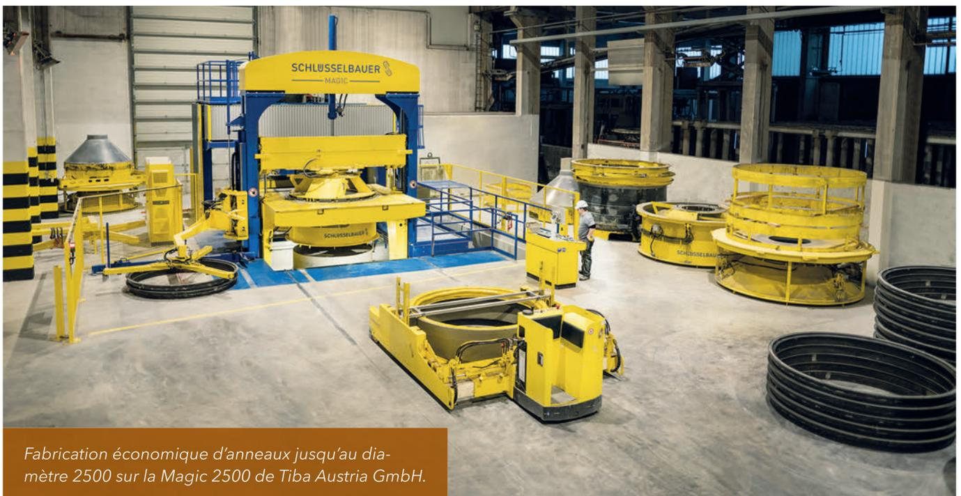
Fabrication économique d'anneaux jusqu'au diamètre 2500 sur la Magic 2500 de Tiba Austria GmbH.
