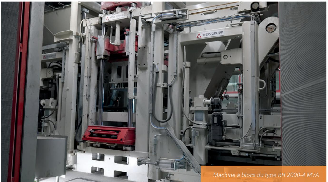
Machine à blocs du type RH 2000-4 MVA
