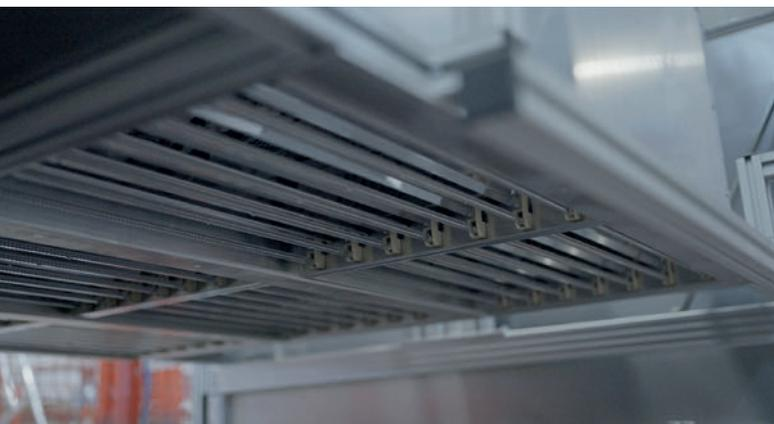
Module de chauffage de la ligne de revêtement
