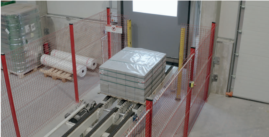
Fertiges Steinpaket mit Deckfolie
