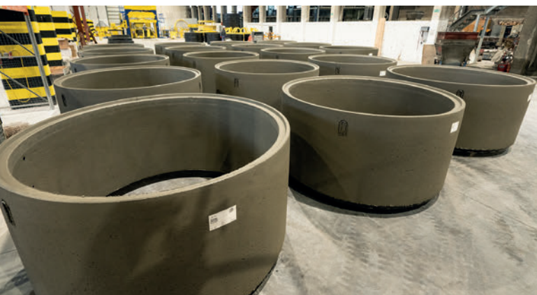
Bis zu 110 Schachtringe DN 2000 oder 90 Schachtringe DN 2500 werden in Sollenau täglich im 1-Schicht-Betrieb hergestellt.
