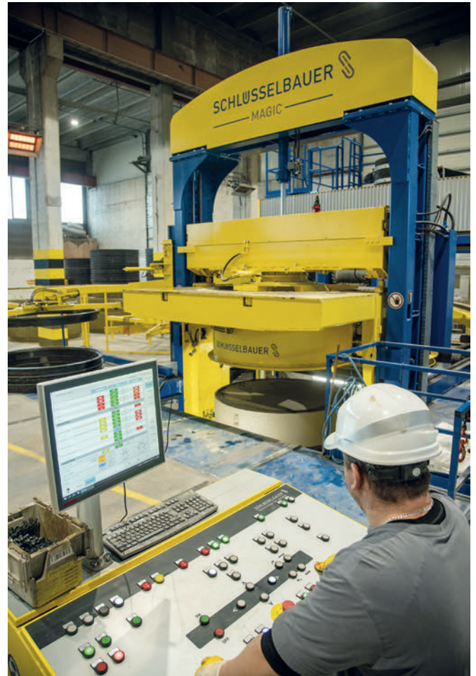
Zum schonenden Entschalen des frischen Produkts werden Form und Presseinheit getaktet hochgefahren.
