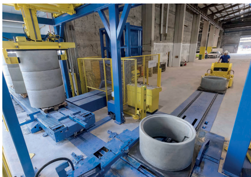
Schachtringe bis DN1500 werden auf der erst 2021 installierten Anlage Magic 1501 gefertigt, wie ausführlich berichtet in BWI 01.2022.
