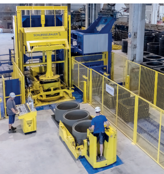
Schachtringe bis DN1500 werden auf der erst 2021 installierten Anlage Magic 1501 gefertigt, wie ausführlich berichtet in BWI 01.2022.
