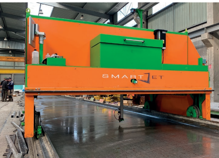
Automatyczny ploter SmartJet umożliwia nanoszenie konturów wkładek formujących, elementów deskowania i otworów.
