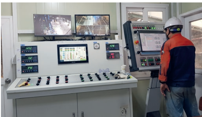
Kabina sterownicza prasy radialnej - wielofunkcyjny panel obsługi z nowym systemem wizualizacji typu Karajan.
