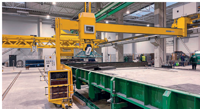
Dopo la stagionatura le superfici in calcestruzzo vengono livellate con una un sistema di lisciatura a pale rotanti elettrico.
