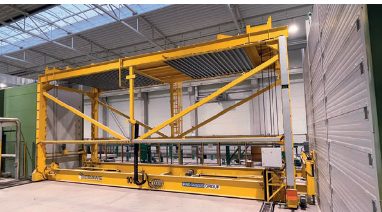
L'trasloelevatore pallet posiziona gli elementi gettati nella scaffalatura di stagionatura.
