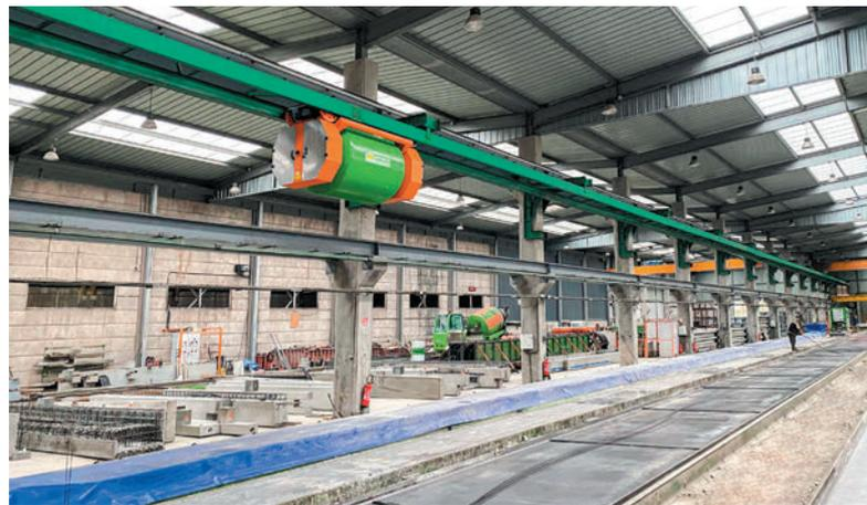
*D-Flyer trasporta calcestruzzo, a consistenza di calcestruzzo umido oppure bagnato, dall'autobetoniera alla posizione prevista nell'impianto di produzione.*
