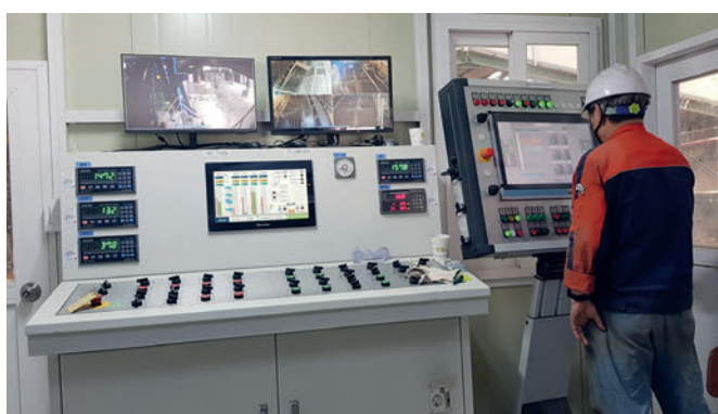
Cabina di controllo con pannello Multipanel RP, incluso il nuovo sistema di visualizzazione delle presse radiali Karajan
