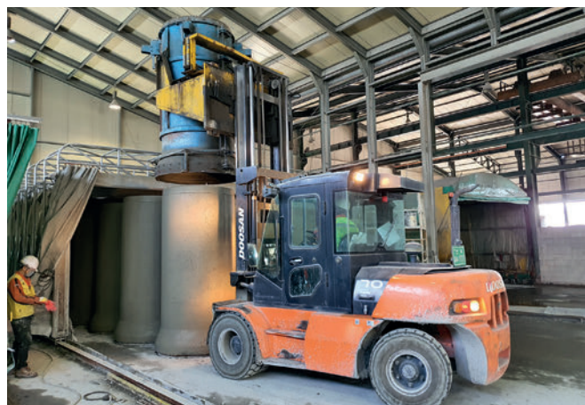
Produzione professionale di tubi in calcestruzzo DN 1000
