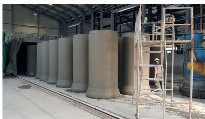
Tubi in calcestruzzo DN 1000 appena disarmati con guarnizione integrata
