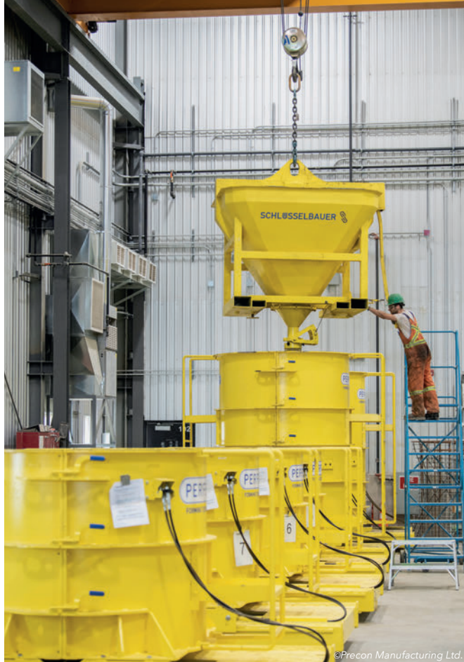
Stampi per altezze diverse vengono riempiti con calcestruzzo autocompattante.
