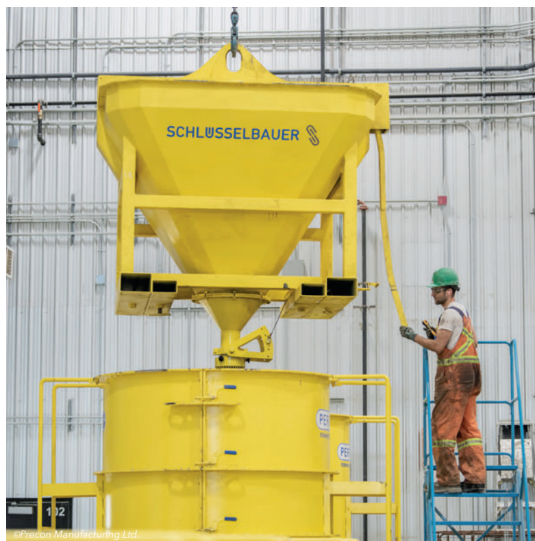
Il silo mobile per il calcestruzzo può essere comandato per mezzo di una gru a cavalletto o di un carrello elevatore.
